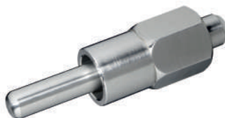
10092-13 a 200 Humedecedora 1/2" para cerdas, caudal agua max 8 ltr/min., con rosca hembra 1/2"
